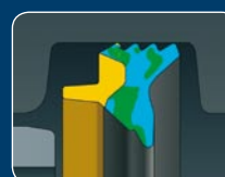
Уплотнение HB-FIX, вставленное в трубу - показан профиль напряжения перед сборкой.
