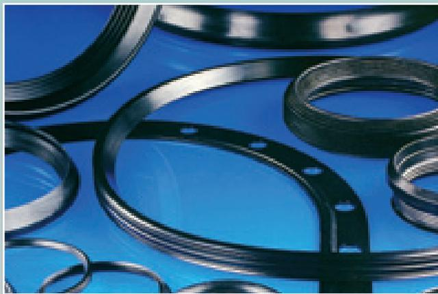
Компрессионные лепестковые уплотнительные кольца для гофрированных пластиковых канализационных труб из Н-ПВХ, ПП, ПЭ в соответствии с требованиями к стандарту DIN 19568 и последующим Европейским стандартам. Из ЭЛАСТОМЕРА в соответствии с EN 681-1 WCL и EN 681-1 WG (маслостойкий)
